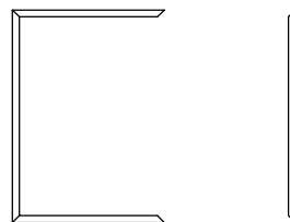
2 - Colocar calzos y rellenar con espuma de poliuretano
