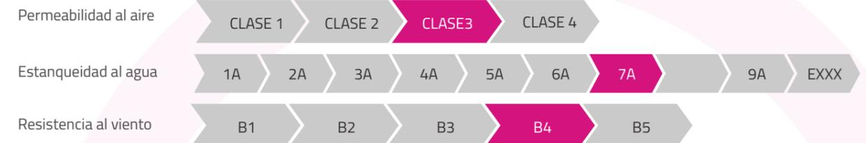
Ensayo de referencia sobre ventana corredera de dos hojas de 3000 x 2500 mm.
