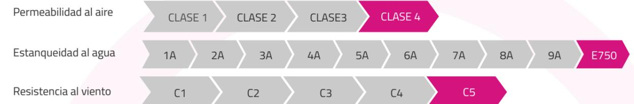
Ensayo de referencia sobre ventana oscilo batiente de dos hojas de 1230 x 1480 mm.
