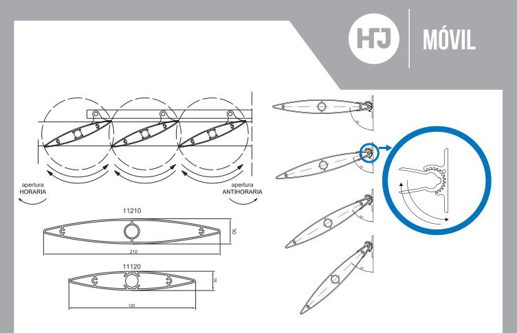
Este sencillo sistema, se compone de un **doble eje retráctil**, doble pletina de conexión, testeros de aluminio lacado, casquillo de fricción en los porta-testeros. La conexión entre tapón y pletina se realizará mediante un bulón remache de alta resistencia y un separador de nylon.
