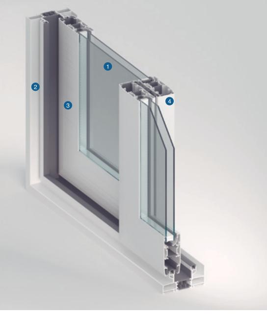
Sistema de carpintería corredera para cargas de 180 kg por hoja, con cierre perimetral desarrollado con juntas de EPDM, que actúan sobre el marco mediante el accionamiento de la maneta.
