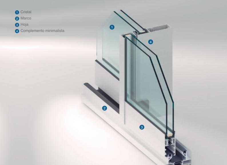
Sistema de carpintería corredera para **cargas de 180 kg por hoja**, con cierre convencional embutido o multipunto, con **juntas de estanqueidad en EPDM triextrusión**, que actúan sobre el marco proporcionando un alta permeabilidad al aire y estanqueidad, así como mejoras en la acústica.
