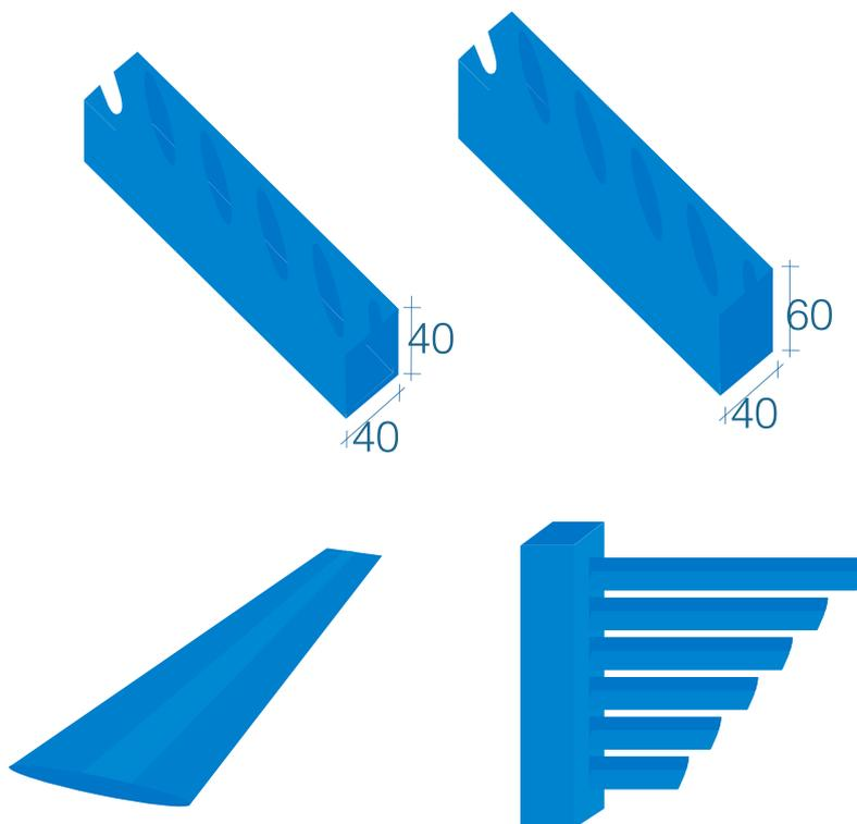
Tubo galvanizado de 40 x 40 x 1,5 y de 60 x 40 x 1,5 mm con troqueles elípticos de 55 x 8,5 mm para la inserción de tubo elíptico de las mismas dimensiones para la fabricación de cerramientos o ventanas de carpintería metálica de fácil montaje y un acabado estético inmejorable.
